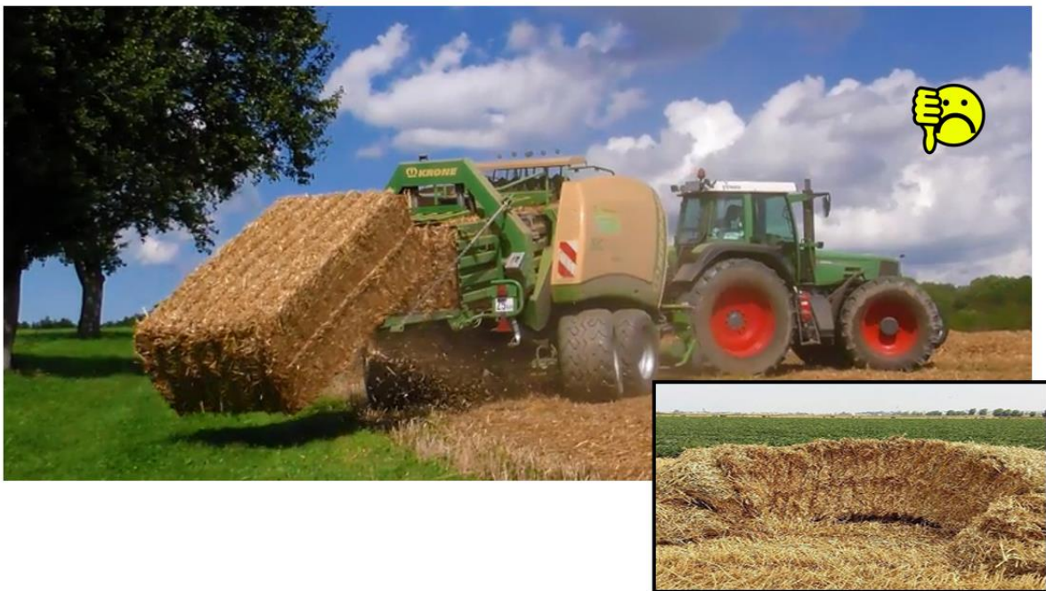
Příklad odložení balíku v momentě, kdy se lis prudce otáčí na souvrati. Následně může dojít vlivem nárazu k prasknutí části motouzů a rozpadu balíku.
